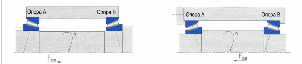
Конструкция (внешнее осевое усилие, F_{ae} , действует на опору A)
