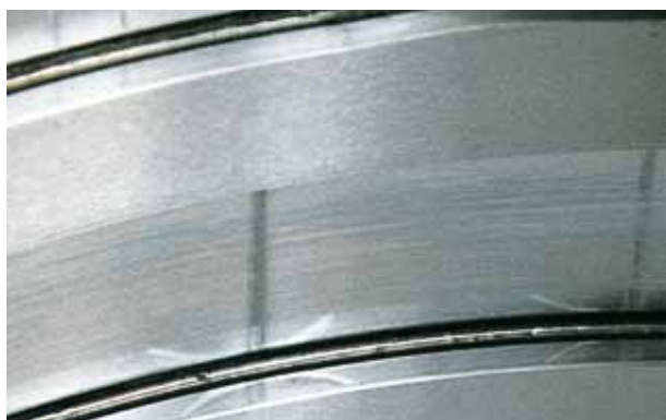
Фото 11.3 Деталь: Наружное кольцо двухрядного цилиндрического роликоподшипника Симптом: Истирание на поверхности следов вращения с интервалом, соответствующим шагу роликов
