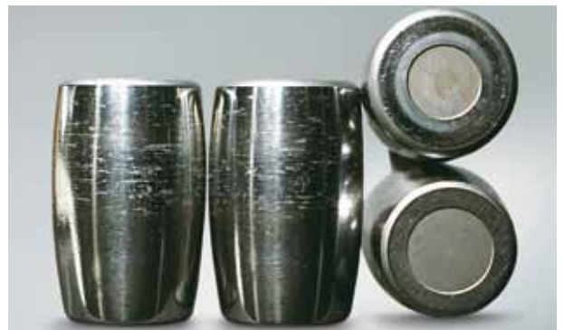
Фото 3.2 Деталь: Сферические ролики с фото 3.1 Симптом: Задир на краю ролика Причина: Проскальзывание роликов вследствие резкого ускорения и торможения
