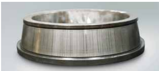
Фото 15.1 Деталь: Внутреннее кольцо конического роликоподшипника Симптом: Полосовой характер коррозии на поверхности следов вращения
