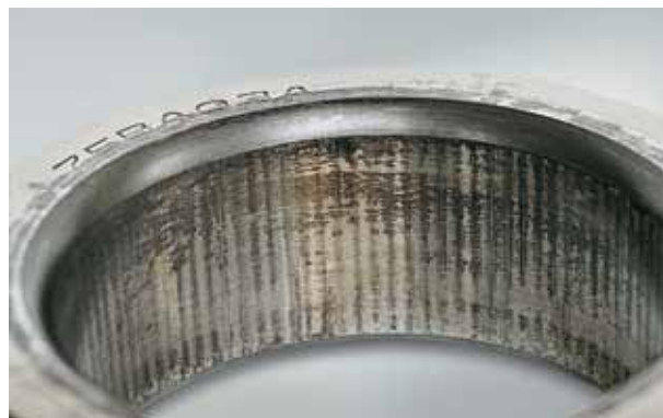
Фото 11.2 Деталь: Внутреннее кольцо радиально-упорного шарикового подшипника Симптом: Значительное истирание по всей периферии поверхности отверстия Причина: Посадка с недостаточным натягом
