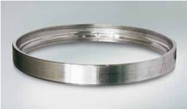
Фото 1.5 Деталь: Наружное кольцо с фото 1.4 Симптом: Усталостное отслаивание поверхности следов вращения, соответствующее шагу шариков Причина: Выбоины в результате ударной нагрузки в неподвижном состоянии
