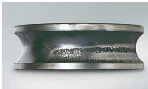
Фото 1.2 Деталь: Внутреннее кольцо радиально-упорного шарикового подшипника Симптом: Усталостное отслаивание по диагонали вдоль следов вращения Причина: несоосность между валом и корпусом в результате неправильного монтажа
