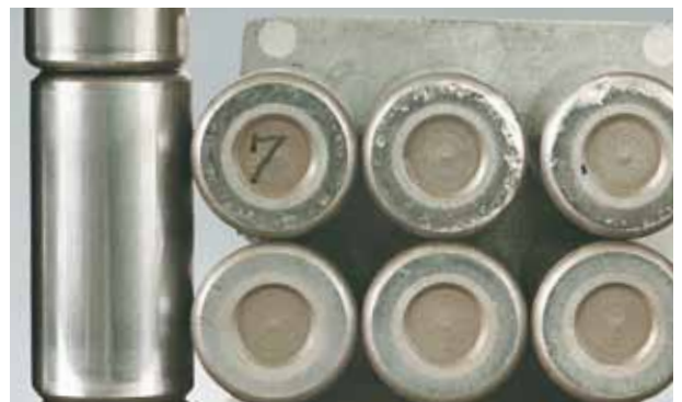
Фото 3.4 Деталь: Ролики двухрядного цилиндрического роликоподшипника Симптом: Задир на краю ролика Причина: Недостаточная смазка и чрезмерная осевая нагрузка
