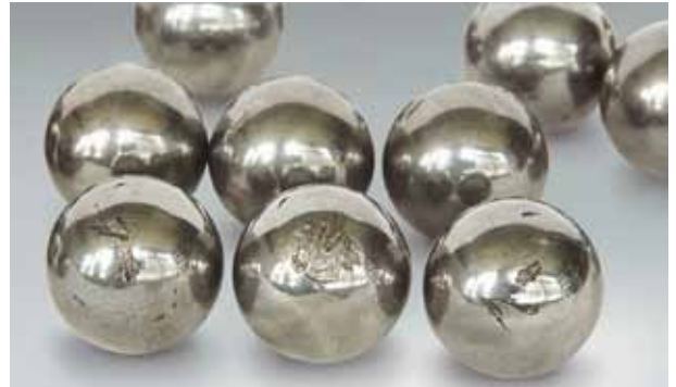
Фото 1.6 Деталь: Шарики с фото 1.4 Симптом: Усталостное отслаивание поверхности шарика Причина: Выбоины в результате ударной нагрузки в неподвижном состоянии
