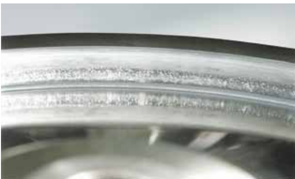
Фото 3.3 Деталь: Внутреннее кольцо конического упорного роликоподшипника Симптом: Задир на поверхности буртика внутреннего кольца Причина: Инородные частицы смешиваются со смазочным материалом и разрывают масляную пленку под воздействием чрезмерной нагрузки
