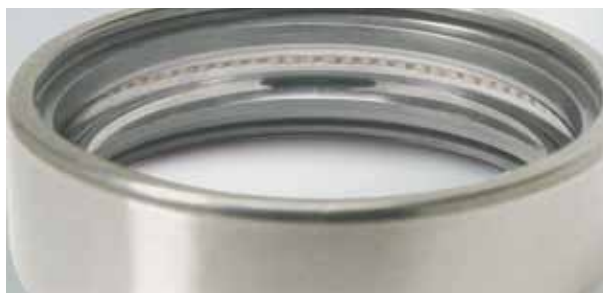
Фото 15.6 Деталь: Наружное кольцо шарикового подшипника Симптом: Рефлексии на поверхности следов вращения (высокой частоты)
