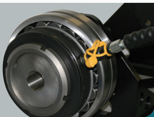
Снятие закрепительной втулки с помощью гидравлической гайки
