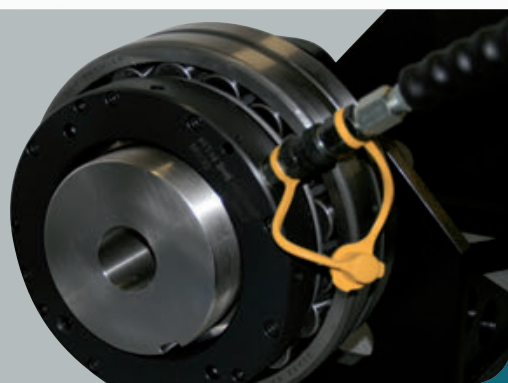
Снятие стяжной втулки с помощью гидравлической гайки
