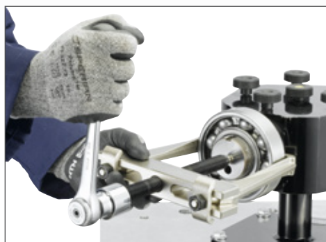
Демонтаж при помощи захвата
