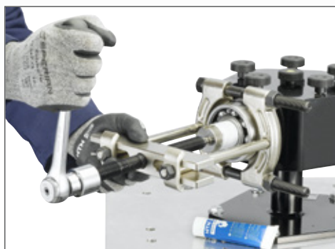
Демонтаж при помощи экстрактора
